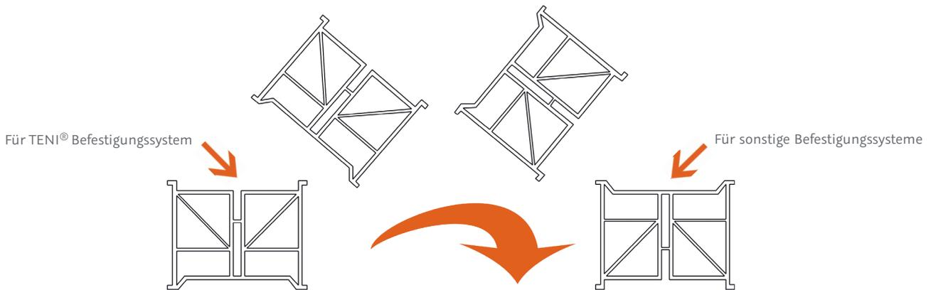
ALUC-L / ALUC-S ist beidseitig verwendbar für jedes verfügbare Befestigungssystem!
